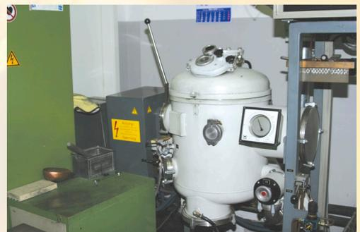
Bevorzugt bei Platingruppenmetallen – Vakuum bzw. Schutzgas garantieren hohe Reinheit.
